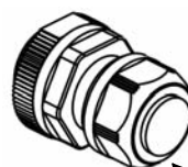
キャプコンの 適合ケーブルサイズ：φ7mm～φ9mm
